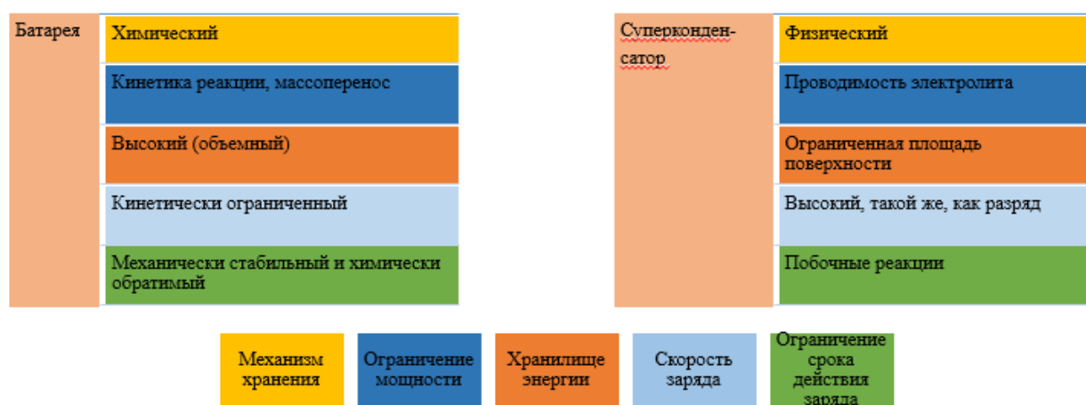
Рисунок 1. Сравнение батарей и суперконденсаторов по различным рабочим параметрам [2]
