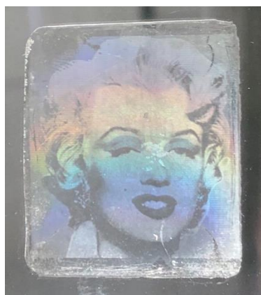
Рисунок 1. Полученная голограмма на полимере в момент отливки слитка
