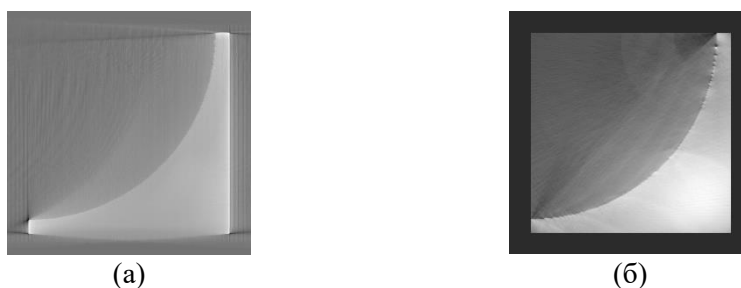
Рисунок 1. (а) Изображение среза фантома в режиме обычной КТ; (б) Изображение маммографического среза, который был сделан в том же месте с использованием дополнительного модуля для режима маммографии
