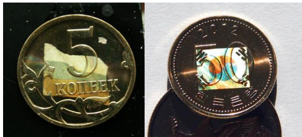
Рисунок 1. Фотографии монет, напечатанных с радужной голограммой со стерео иллюзией флага, появляющегося ниже поверхности монеты.
