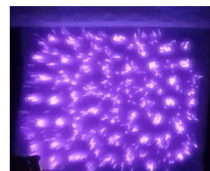
Рис. 1. – Вид сверху микроразрядов (без потока воздуха): 3 мм и Частота съемки 24 кадр/сек, время экспозиции 40 мс
