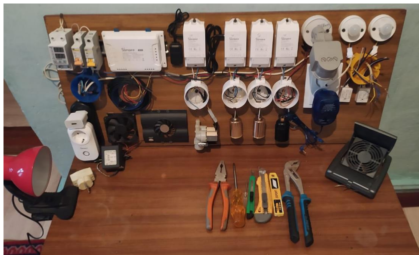
Рисунок 1. – Лабораторный стенд по беспроводным реле Wi-Fi реле и современных датчиков для проектировки электрических схем «умных домов».
