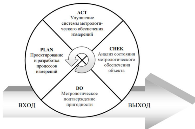
Рисунок 1. – Цикл Деминга, применительно к процессу метрологического обеспечения измерений
